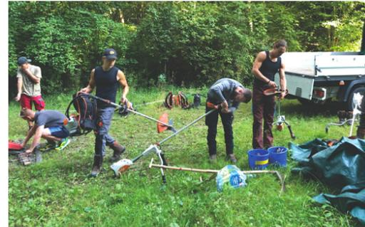
Zivis wechseln Messer am Balkenmäher und bereiten die Motorsense für's Mähen vor.
